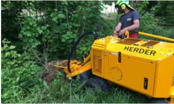
Durch die Wahl des hydraulisch Antriebs haben Sie mit dem Fräsrads maximale Bewegungsfreiheit, da mechanische Beschränkungen fehlen. Des Weiteren haben Sie die Sicherheit einer voll einsatzbereiten Maschine mit minimalem Verschleiß in den Antriebsteilen.
