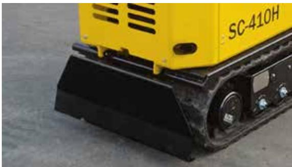
Die SCT-410H wird standardmäßig mit einem Planierschild ausgestattet. Dieses Planierschild wird benutzt um den Sägespäne direkt in das entstehende Loch zu schieben. Auch kann das Planierschild verwendet werden, um dem hinteren Teil der Stumpfräse hoch zu drücken und zu stabilisieren. Hierdurch wird der Tiefenstellung unter den Platz erweitert.
